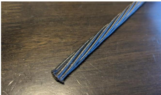
HPC（ハイブリッドプレストレストコンクリート）で使用しているカーボンワイヤー
