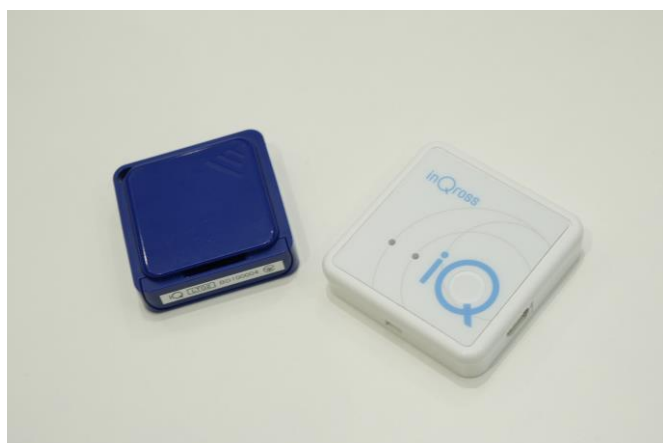
InQrossで利用される小型無線機「ロケタグ」と「ヒトタグ・モノタグ」 BLUETUSの技術も活かされた、屋内での動作を見える化する装置だ
