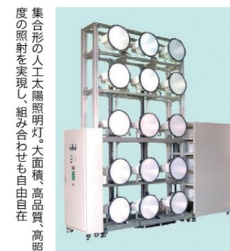
集合形の人工太陽照明灯。大面積、高品質、高照度の照射を実現し、組み合わせも自由自在
