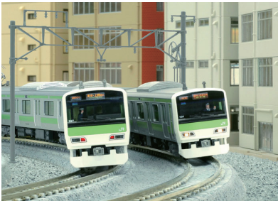
床下の細かい機器類まで再現したNゲージの山手線。コンクリート枕木やカント付きの曲線線路もリアル。ちなみに「Nゲージ」はレールの間隔が9mm。9は英語でNineなので、この頭文字から名付けられた
