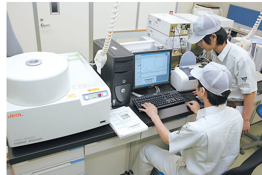
蛍光 X 線分析装置による検査風景。インキ内の原材料に含まれる成分を測定し、混入を防止する
