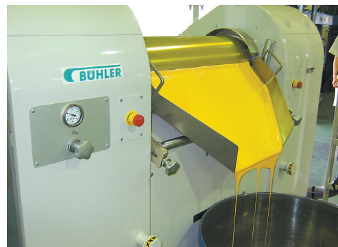
スクリーン印刷インキの製造工程・ロール作業。攪拌を終えたインキ材料をロールミルで分散すると、粒子がさらに細くなる
