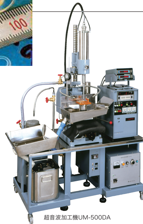
アルミナ基板打抜加工の事例
