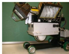
**NRC式煙突用遠隔操作カメラ**
