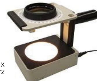
偏光や波長の光学特性を利用して、ガラスなどの透明体の検出・測定する「歪検査器」
