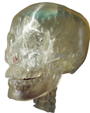
光造形医療モデル。血管位置などの個人データを基に再現した頭蓋骨
