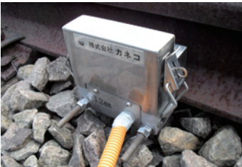
「道床沈下検知装置」。軌道の変状計測器の一種で、傾斜感知器や伸縮感知器と組み合わせて利用している
