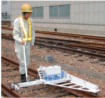
測定からプリントアウトまでの機能をコンパクトに搭載した軌道検測装置。「トラックマスターオートタイプ」。高低、軌間、水準などが検測可能
