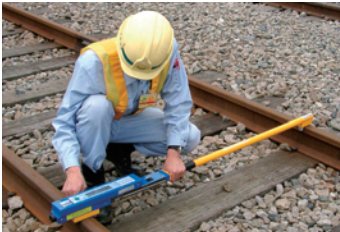
軌間、バックゲージ、水準、平面性をデジタルで計測できる「ゲージタイプ平面性測定器」
