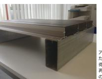
再生プラスチック使用の 荷台は、汚れや腐食に強いので補修費削減が期 待できる。軽量化により 積載量を増やせるのも大きな魅力だ
