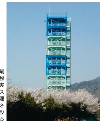
定常流量排水・器具・洗剤排水の付加実験、排水騒音試験などの排水能力実証を行う同社の排水システムタワーは、品質管理に欠かせない存在。高さ約30mの大規模な施設で、日々研究を重ねている
