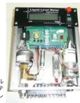
内蔵されているセンサは、30 年にわたり、液面レベルの検出に使われてきたステンレペラ（接液部がステンレス薄膜の微圧センサ）
