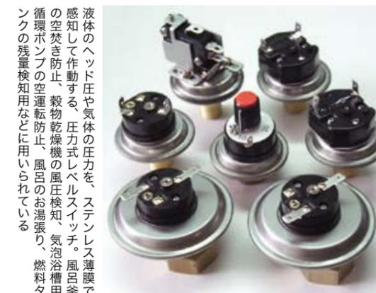
液体のヘッド圧や気体の圧力を、ステンレス薄膜で感知して作動する、圧力レベルスイッチ。風呂釜の空焚き防止、穀物乾燥機の風圧検知、気泡浴槽用循環ポンプの空運転防止、風呂のお湯張り、燃料タンクの残量検知などに用いられている。
