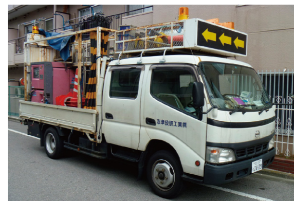
外部の設備や車両などに電力を供給する電源車
