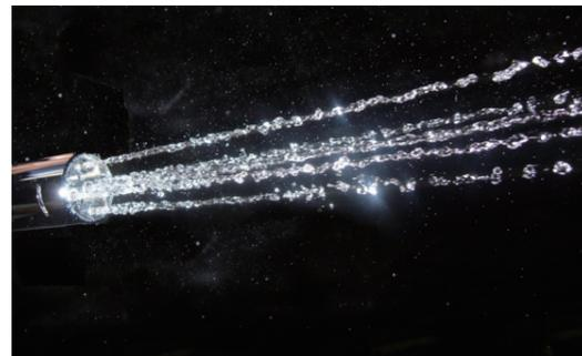
特殊開発ノズルの放水状況。放たれた水は、水玉状で飛んでいき、7～8m先まで、横90cm、縦1.5mの楕円形に広がり、燃焼物からみづくように消火する
