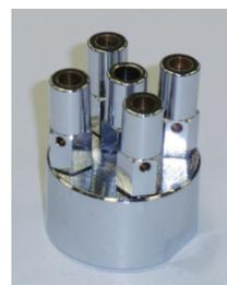
簡易水道消火装置(街かど消火栓)の消火用ノズル装置。5つの先端は、径の大きさがそれぞれ異なり、横に小さな穴が開いていて、空気を取り込む仕組み。この開発ノズルが高い消火効果を発揮し、消火作業を容易にした。水道圧を利用し、電気や石油などのエネルギー源を一切使わないため、環境に優しい製品でもある
