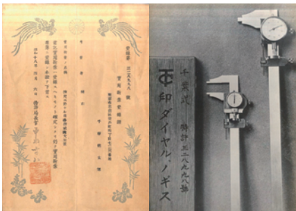
千葉製作所の創立者であり、千葉社長のご祖父、千葉佑太郎氏が発明した「ダイヤルノギス」（右）と昭和18年発行の実用新案登録書（左）
