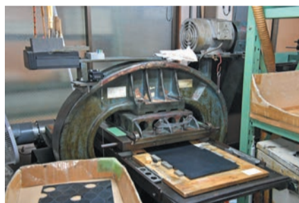
毎日のメンテナンスにより50年以上使い続けている加工機と30年以上使い続けている抜型
