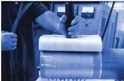
約60年以上にわたるホテル向け銀メッキ補修事業の経験をいかし、現地へ出張して行うオンサイト・プレーティング出張メッキ補修サービスを行っております。メッキ槽に入らない・入れられない製品でもメッキ加工が可能です。熱ひずみの心配がない、新しい肉盛り補修・防錆・防食等、既存設備・機器への新しいメンテナンス・めっき方法としてご検討下さい。
