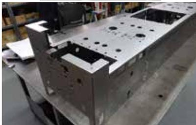
レーザー加工、板金加工等の試作から量産まで対応致します。
