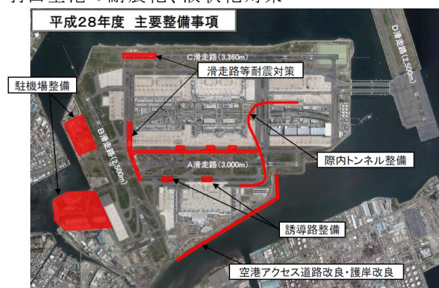
羽田空港の耐震化、液状化対策
