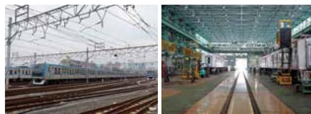
深川車両基地の総敷地面積は約8.2ha。車両の検修計画や工程管理、在庫管理など担う「深川車両管理所」、車両を分解して部品ごとに検査・修繕を実施する「深川工場」、通電状態で検査・修繕を行う「深川検車区」の3部門で構成されています。
