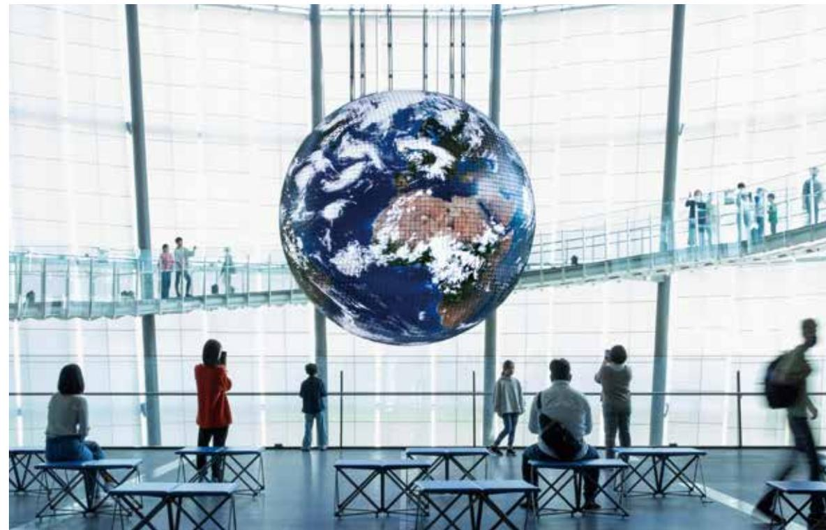
「ジオ・コスモス」は10,362枚ものLEDパネルで映像を映し出す球体ディスプレイ。気象衛星から取り込むデータを基にダイナミックな雲の動きなどを鑑賞できます。
