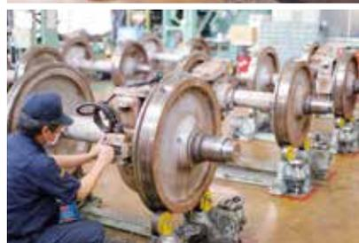
深川車両基地で最も大がかりな作業が車両本体と台車を分離する“台抜き”。車両を専用クレーンで持ち上げて台車を外し(写真上)、細かいパーツに分解してから検査・修繕を行います。車両の下に潜り込んでの打音検査(写真中央)、車輪のチェック(写真下)など、いずれも社員の経験がものをいう作業です。
