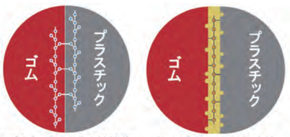
ラジカロックによる直接接着 接着剤を使った間接接着
