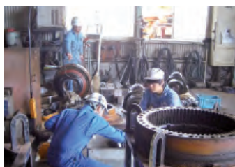
減速機のオーバーホール。どれをとっても大きいため作業は大掛かりだ。
