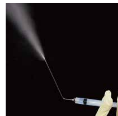
気管内噴霧スプレー マウスなどの動物にできるだけ負担をかけることなく 気管内にウイルスや薬液を噴霧することが可能
