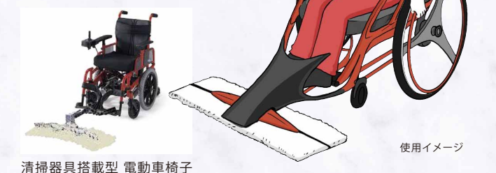
清掃器具搭載型 電動車椅子
