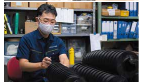
ジャバラ作りはほぼ手作業。耐熱、耐冷、耐薬品、耐圧など使用環境に応じたオーダーメイド製品に1個から対応しています。
