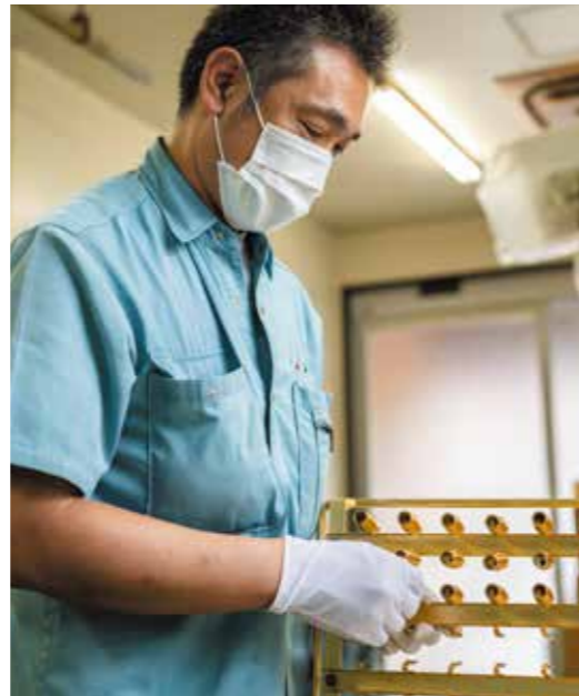
「治具」と呼ばれる装置に製品を取り付けて電気を流します。製品の形状に合わせて、治具もさまざまな種類が用意されています。
