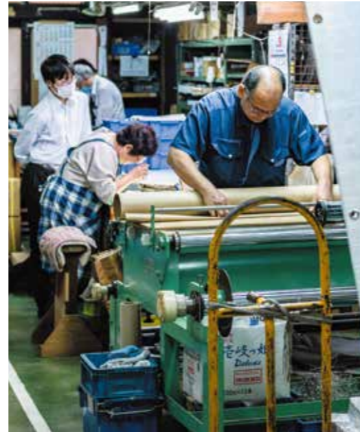
織り上げた金網をカットしたり成形したりして、フィルターなどの製品を作り上げます。品質に不備がないかもしっかりとチェック。
