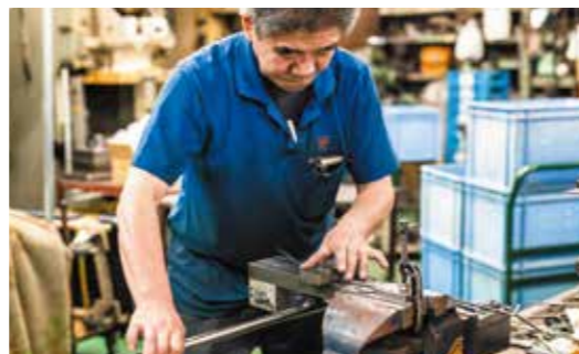
金属の棒を曲げ店頭で使用されるさまざまなディスプレイ器具を製造。
