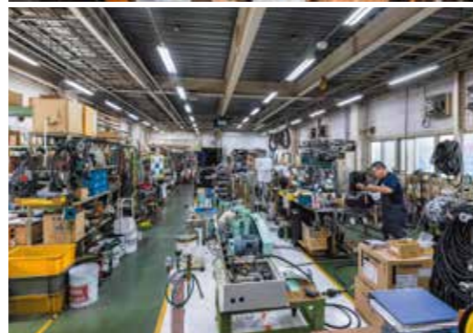
工場では、潜水用、消防救急用、産業用、研究用など、多種多様なコンプレッサーを製造。特殊仕様にも柔軟に対応しています。
