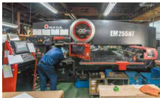
多種多様な形状の金型を機械にセットし、パンチ加工を行います。
