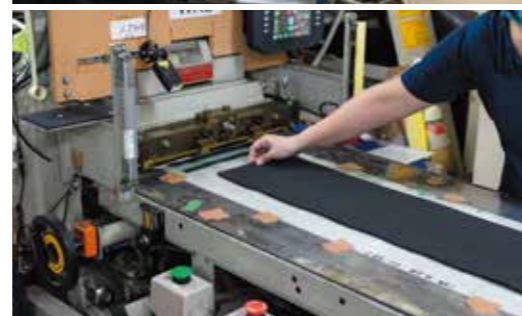
ゴムスポンジを機械で正確かつスピーディにカット。小さなミスも起こさないように、製造工程の管理体制も徹底しています。
