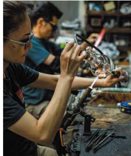
オーダーメイドのガラス器具の大きさや形は多種多様。複雑な形状のガラス器具も、一つひとつパーナーを用いた職人技で仕上げます。
