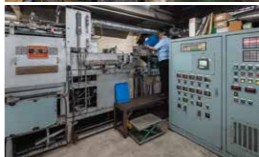
加工を終えたネジを高温で熱して急激に冷やし、再度加熱する「焼き入れ」と「焼き戻し」を行い、硬度と強度を向上させます。
