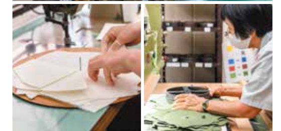
均一に研磨ができるように、生地の種類や全体の枚数に合わせて、縦糸と横糸の目を少しずつずらしながら手作業で重ね合わせます。
