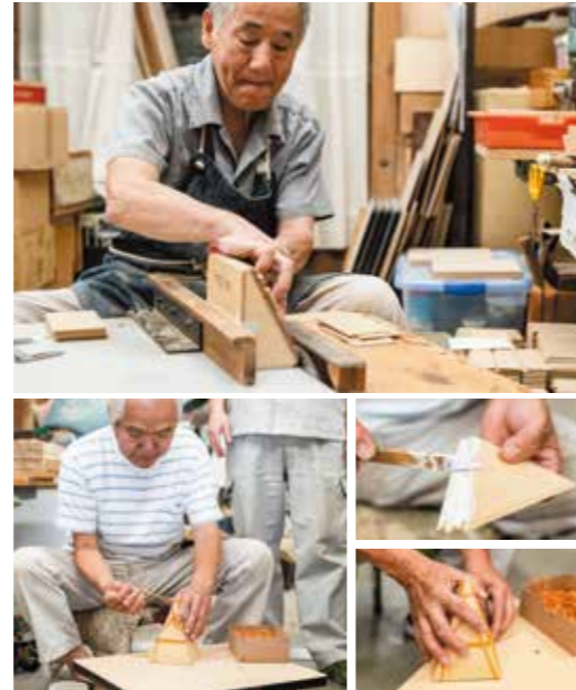
板同士を正確な角度で素早く接着するのは熟達した職人のなせる技。輪ゴムを使って隙間なくピッタリと貼り合わせます。
