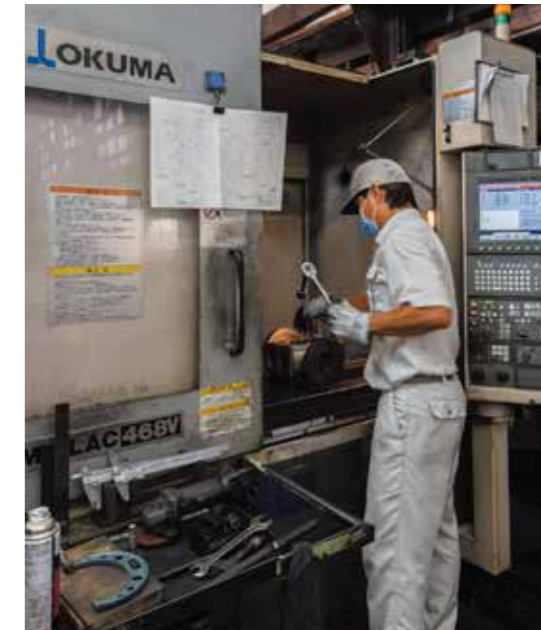
流す液体の種類や量、温度などによってギヤポンプの構造はさまざま。一品一様の設計に合わせた機械加工を行います。
