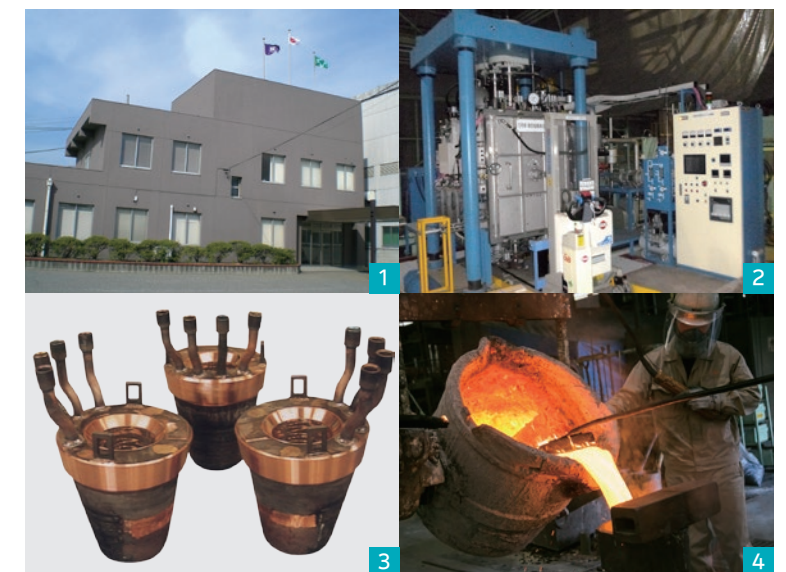
1. 非鉄金属の鑄造、加工、溶接のパイオニアとして北九州市で操業している戸畑製作所 2. 異種金属の接合が可能な拡散接合炉 3 4. 高炉用送風羽口をはじめさまざまな純銅鑄物を製造
