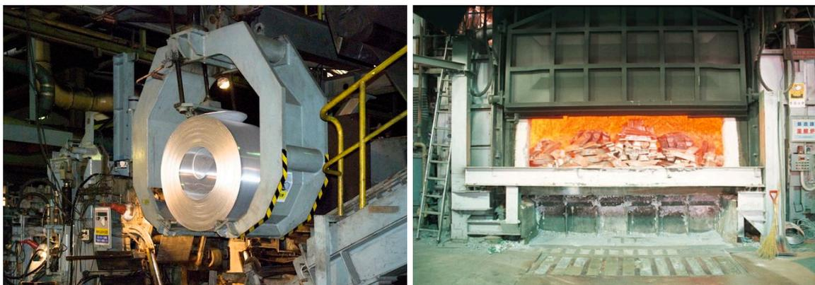
図表 6: (左)圧延製品ライン(右)省エネルギー仕様の溶解炉
