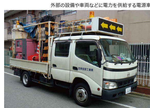
外部の設備や車両などに電力を供給する電源車
