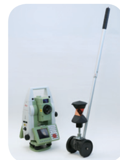
道路を転がすだけで測量 できるコロコロ測量の開発
