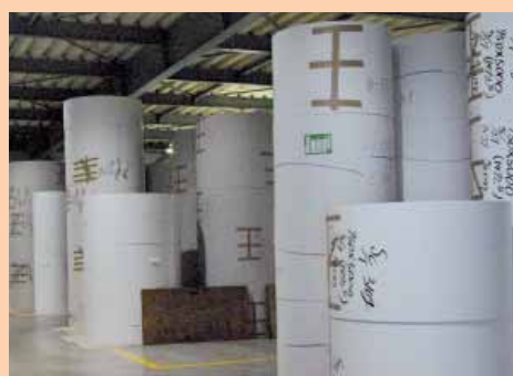
重量2 t近くの板紙ロール。幅は各種あり、数本並べて積み込む際は荷台幅の余裕が片側3 cm以下になることもある。
