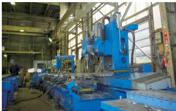
穴開け等を行うMC機器。 精度を要する部分については機械を使用するが、最終的には人の手との融合により製品ができあがっていく。
