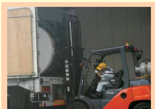
巻き取り紙をつかんでいる時は前方が見えない。横から確認し、トレーラーとロール双方の端に合わせる。熟練の技術を要する仕事。
