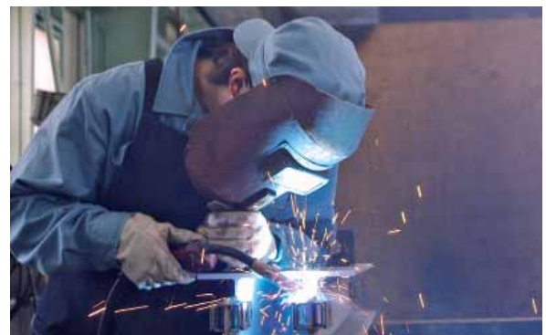
熱を加えると歪みが生じる。それを平らに修正していくのは、「鉄の生き物」を育てるという熟練の技術。 10mの鉄材であっても誤差は2mm以内に収める。
