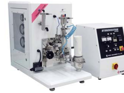
母粒子を表面改質し、機能性複合粉体材料を作り上げる「ハイブリダイゼーションシステム」
