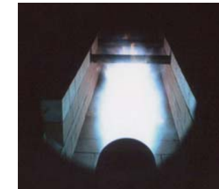
フリメーション（火葬）バーナの炉内燃焼の様子。火炎の直進性と長炎性が特長
