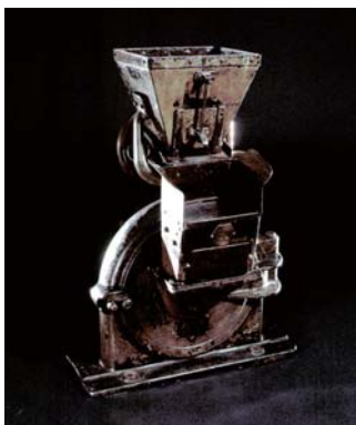
1925年開発、国内初の高速回転衝撃式粉碎機「自由粉碎機」
