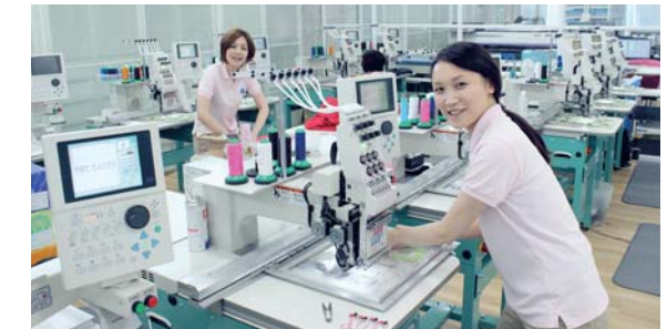
ファクトリーでは、刺繍ウェブシステムを活用して、発注者の指示通りに刺繍や名入れをしていく
