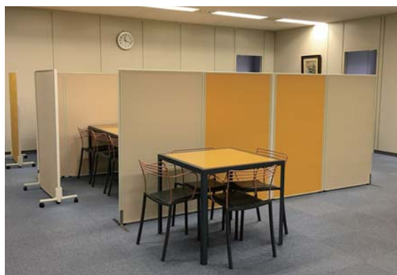
打ち合わせスペースでの「吸音ローパーティション」導入例。隣席の音が反響するのを抑え、話がしやすい環境に
